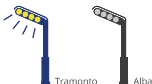
Controllo da quadro Gestione del circuito elettrico per singolo quadro
